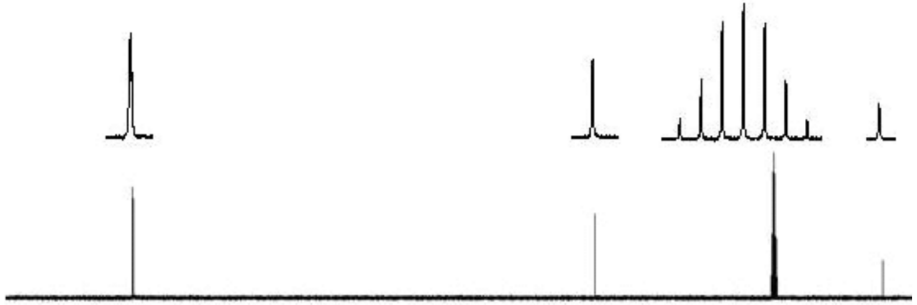
图 3 用 NNAPC 算法对图 2 所示的 ^{13}\text{C} 去偶谱进行自动相位校正结果图
