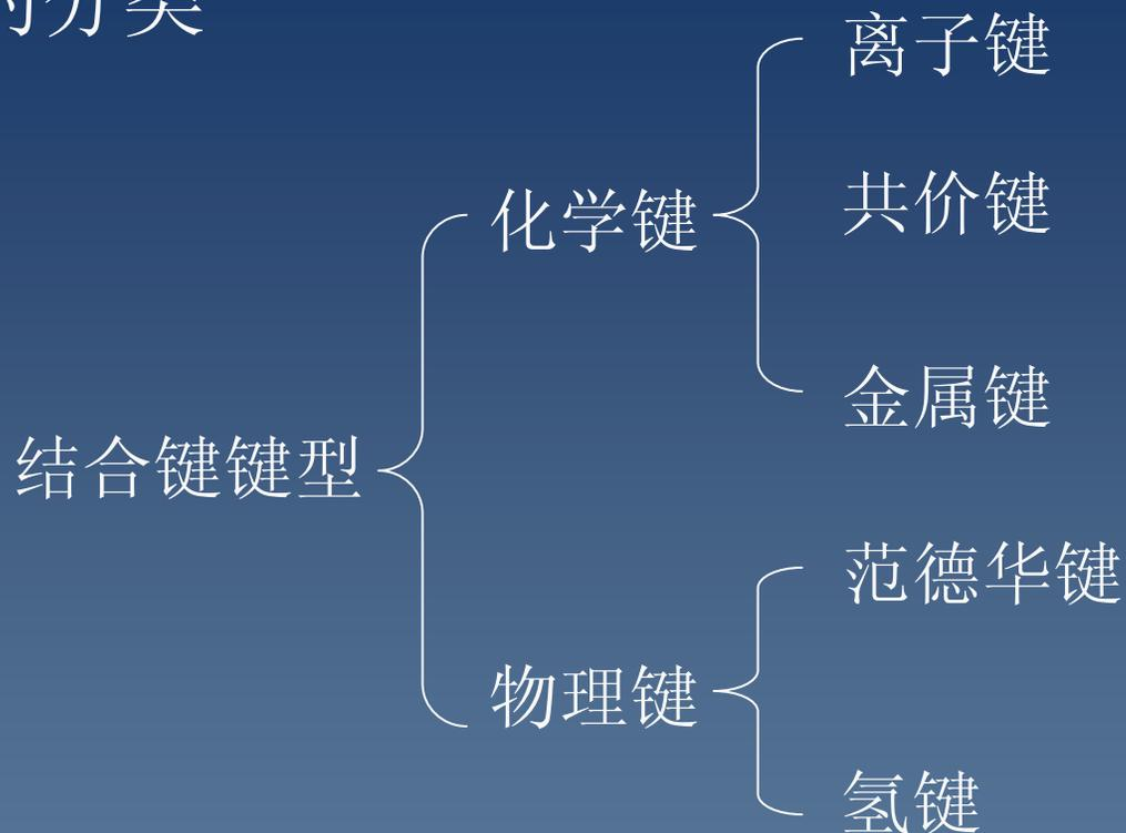
结合键能越大，原子结合越稳定；离子键，共价键的键能最大；金属键较低，过渡族金属最大；范氏低，氢键稍高。
