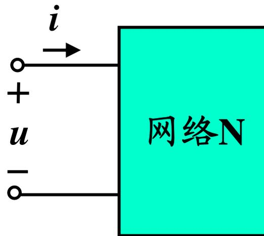
此电路中，电压中有三次谐波，但电流中没有三次谐波，所以**三次谐波的功率为零**
