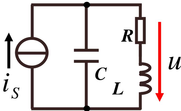
已知:  $R = 20 \Omega$ 、 $L = 1 \text{mH}$ 、 $C = 1000 \text{pF}$
