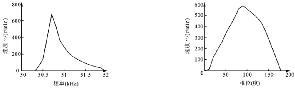
图 4 单定子的球转子转速与频率、相位差的特性曲线
