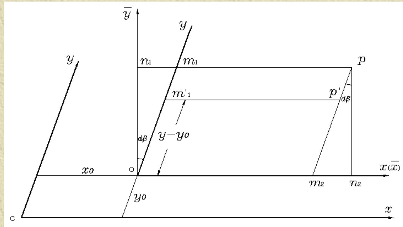
$(\bar{x}, \bar{y})[on_2, on_1]---$  以像主点为原点，不包含线性误差的像点 $p$ 的坐标；
