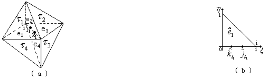
图 3 (a) \tilde{\gamma}_l 支集内的单元 (b) 标准三角形 \hat{e}_1 上的插值点 j_l 和 k_l
