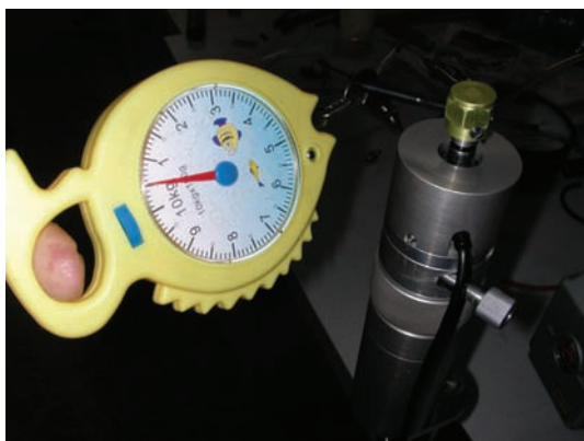
图5 机器人关节锁紧性能测试实验
