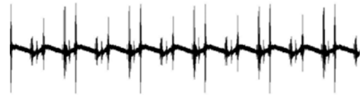
图 2 焊接电流的 \mu\text{s} 级波形
