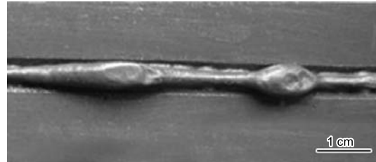
图 7 高速焊的驼峰焊道
