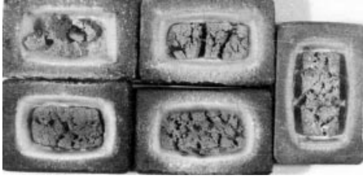
Şekil 2. 1400 °C'ta 2 Saat Süreli KTİN'de Görülen Elyaf Yapı
