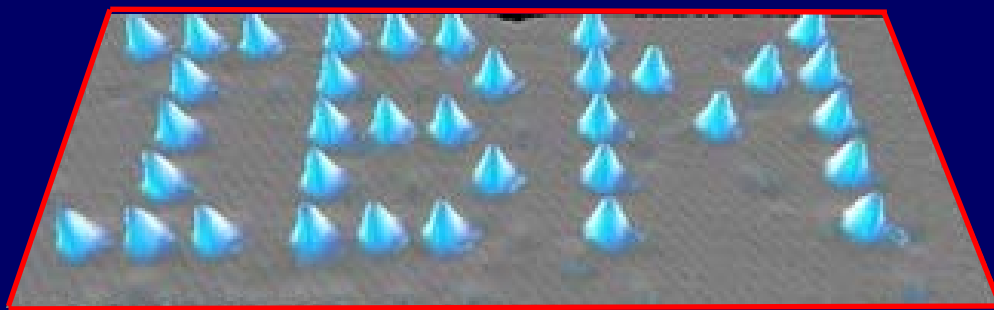
扫描隧道显微镜操控原子排列成“IBM”字样
