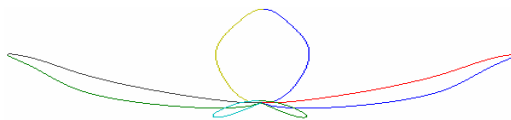
图8 调节因子由对应的连续因子按局部最小能量法用 Cotes 公式求得 \kappa_1=5.0, \kappa_2=1.0
