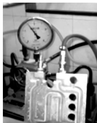
图 7 冷板打压照片
