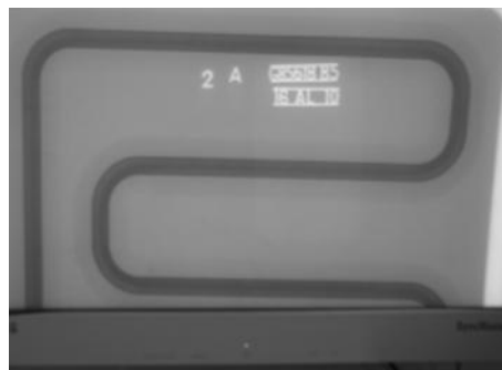
图 5 冷板 X 射线探伤底片
