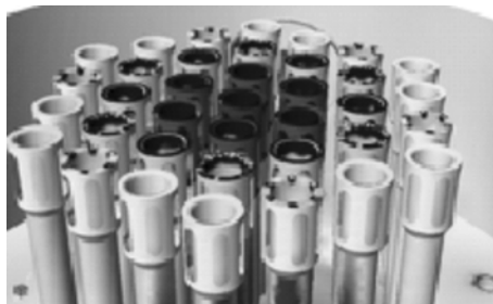
图 2 大栅板联箱内部结构
