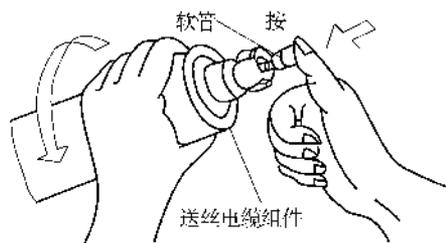
图 15-17 送丝软管送入送丝电缆中
