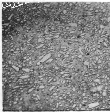
图 7 軋制态硼不銹鋼阴极真空蝕刻 (放大 135 倍)
