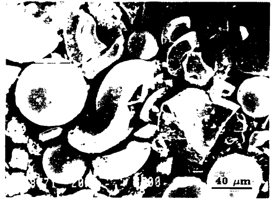
图 2 熔融 Ti+HA 颗粒的空心形态
