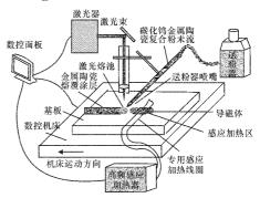
图 2 激光感应复合快速熔覆装置示意图 Fig. 2 Schematic for setup of laser induction hybrid rapid clading
