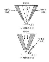
图1 自动送粉法激光熔覆示意图
