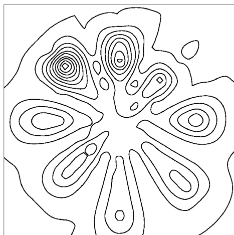
图 2 GL-8-16 微喷头均匀度试验数据网格化插值结果线网图(图 4)表示微喷头的水量分布情况,比等值线图更直观。根据喷洒强度确定等值线标值和间隔。在 Surfer 软件主界面中打开 Map 菜单,选 Contour 项或 Wireframe 项,输入网格文件名(dms. grd),即绘制出等值线图。
