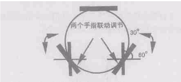
图5 欠驱动手爪调整手指位置形成多种抓取模式
