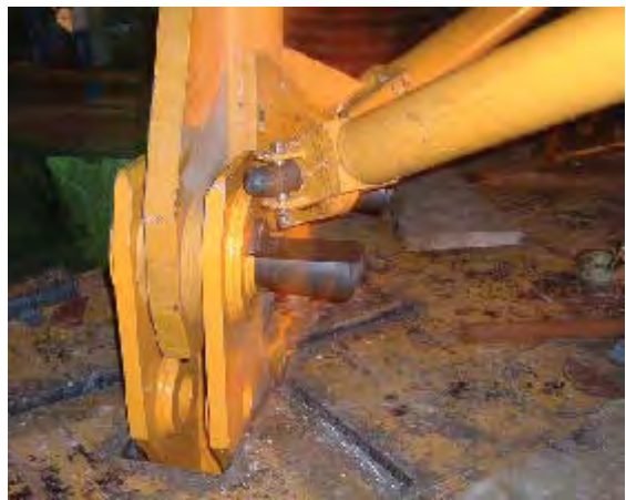
图6 柱脚与塔身标准节的连接
