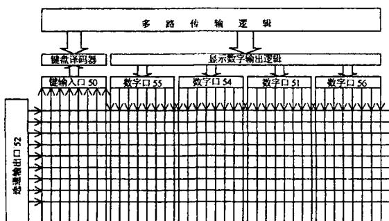
检查 CPU 控制板上的接口 U<sub>14</sub>、U<sub>9</sub> 的 52 输出口和 50 输出口组成 8×8 键盘矩阵网, 以矩阵网横向控制线和纵向控制线上看, 它们的交叉点上有一个控制键或数字键。从故障来看, 其数字键有反应, 而控制键无反映。从横向控制线上有几根横向线上即有数字键又有控制键, 而纵向控制线上有几条也是如此。既然数字键有反应, 控制键也应有反应。反过来若有故障都有故障。再说此芯片另一个 51 输出口是控制显示器, 而此部分显示有反应。由此可见此接口芯片无故障。
