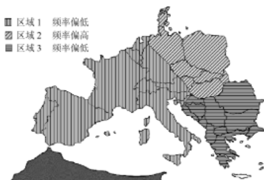
图 2 UCTE 联合电网分裂成的 3 个孤岛
