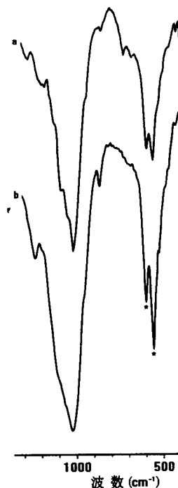
图2 鲨鱼软骨粉的 X-射线衍射图 a. 国产品 b. 进口品 * 1/2 [Ca (OH)_2 \cdot 3Ca_3 (PO_4)_2] 特征峰
