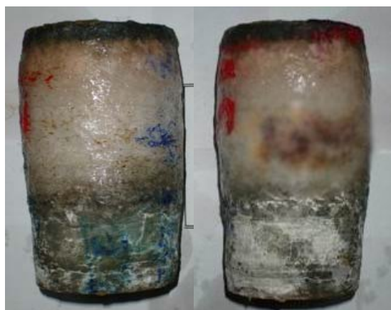
图 6 层状盐岩各层层间的蠕变破坏图片 [18]
