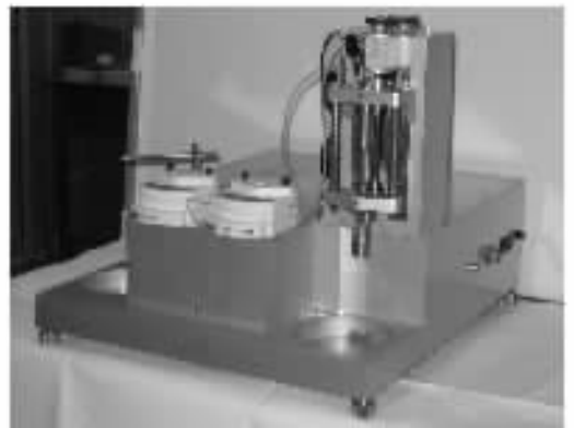
图 5 放射性同位素药液自动稀释分装装置
