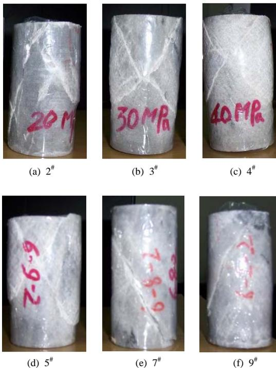
图 7 大理岩卸荷破坏形态
