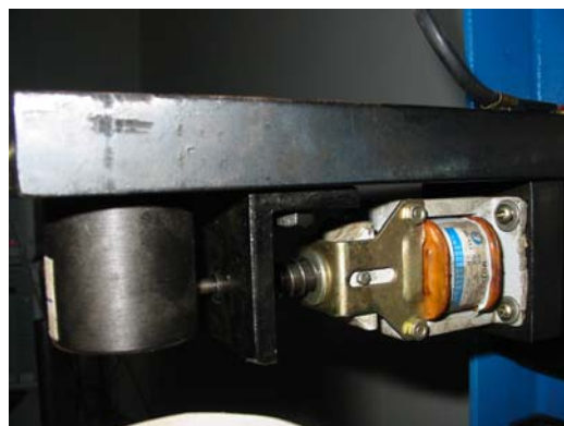
图 5 垂直加载装置及延时器 Fig.5 Vertical impact apparatus and chronotron
