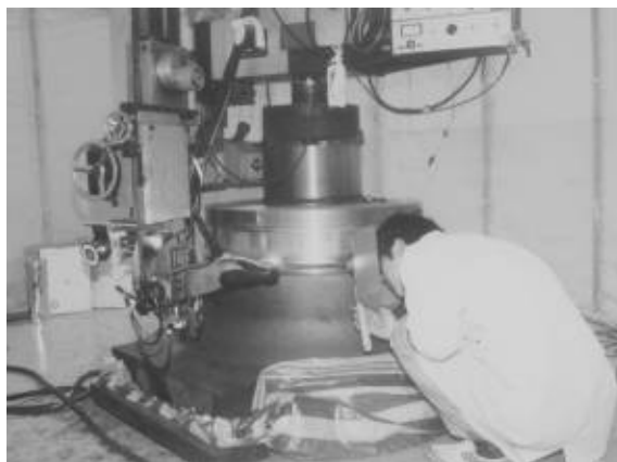
图 25 接管—安全端焊接装置
