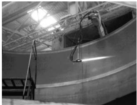
图 37 机器人在喷涂
