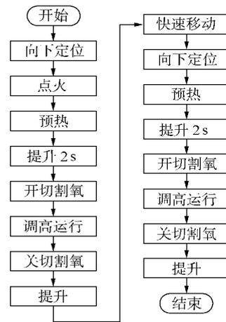
图 4 套料切割程序流程
