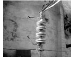
图 3 水平安装的并联间隙布置
