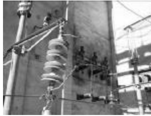
图 7 垂直安装的并联间隙试验后状态
