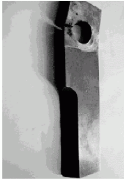
图7 动刀片断裂实例
