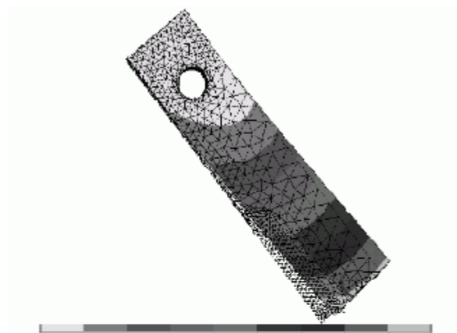
图4 刀片变形及节点位移
