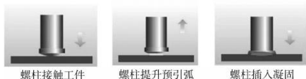
图4 拉弧式螺柱焊接工作过程
