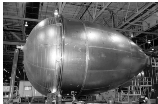
图 19 环缝变极性等离子焊接件
