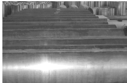
图 18 纵缝变极性等离子焊接件
