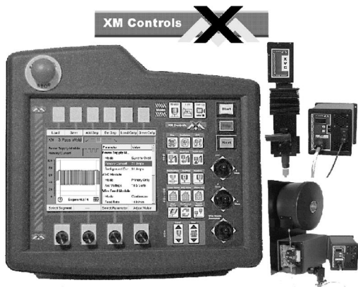
图 16 XM 焊接控制系统
