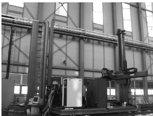
图 22 纵环缝铝合金变极性等离子焊接系统
