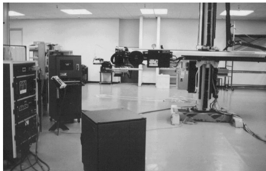
图 20 立式变极性等离子焊接系统
