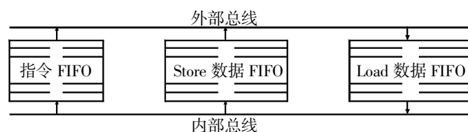
图 1 IOSS 缓冲模型
