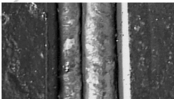
图 3 自然光下的焊缝图像 Fig.3 Seam image in natural light
