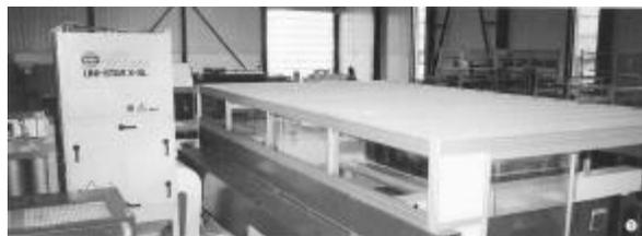
图 2 隔栅式的切割平台侧面
