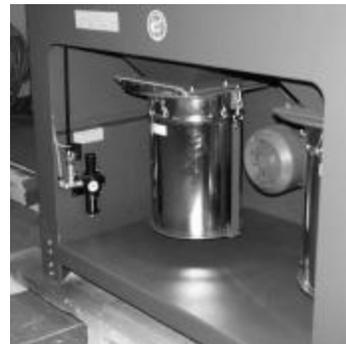
图 10 带粉尘液位标高传感器的灰桶
