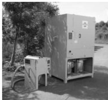
图 11 带干式定量添加装置的除尘系统
