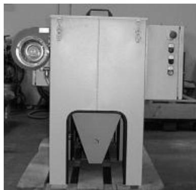
图 12 自动化的干式定量添加装置侧面
