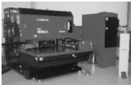
图 6 实际运行中,除尘器往往被要求与激光系统一起摆放在室内,因而对除尘过滤效果要求较高
