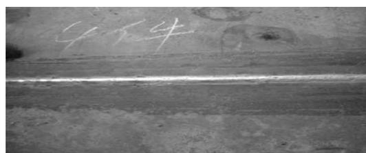
图 3 20 mm 厚钢板对接反面成型
