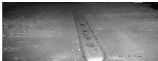
图 2 20 mm 厚钢板对接正面成型
