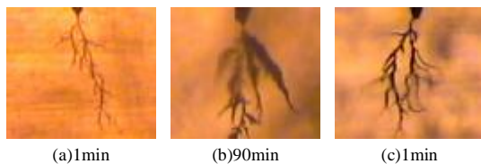
图 6 图 4 电树枝初始结构
