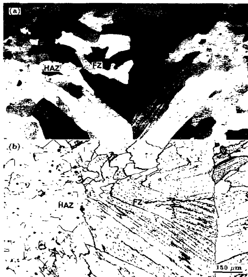
图 4 电子束焊接 \text{Fe}_3\text{Al}(\text{CrNbC}) 和 \text{Fe-16Al}(\text{CrMoNbYC}) 合金的焊接区组织
