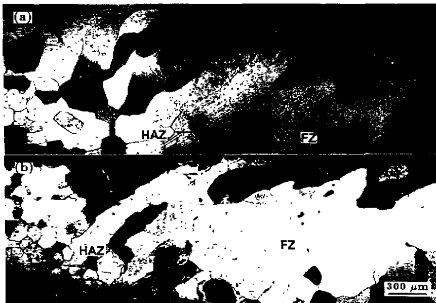
图 1 Fe_3Al(CrNbC) 和 Fe-16Al(CrMoNbYC) 合金的焊缝区组织
