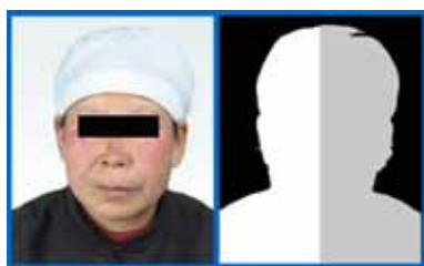
图 7 原图与阈值法获得的人像轮廓掩码位图
