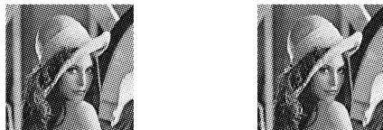
(a) Lena 小波图像的完全重构 (b) 少了 HH_1 子带重构的图像 图 1 人眼视觉特性测试
