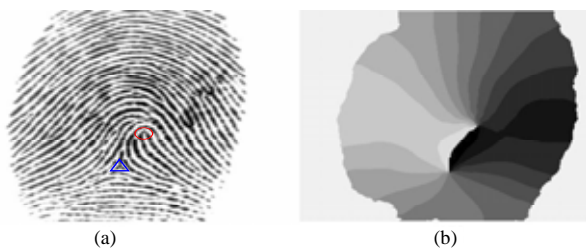
图 1 指纹图像的奇异点和方向图 ○ 标记中心点的位置, △ 标记三角点的位置
