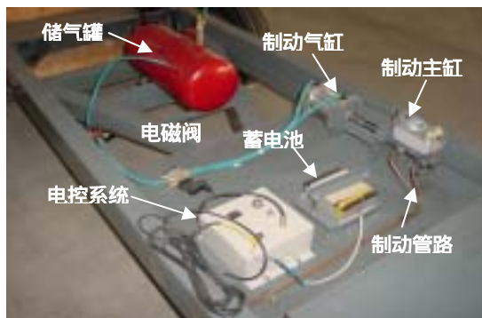
图5 移动屏障制动系统
