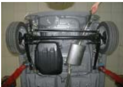
图 10 燃油箱的合理布置方式图
