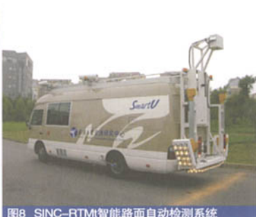
图8 SINC-RTM智能路面自动检测系统
