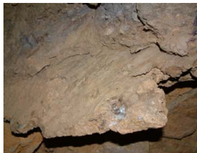
图 8 坡积层中的局部滑移面 Fig.8 A scrape of local sliding
