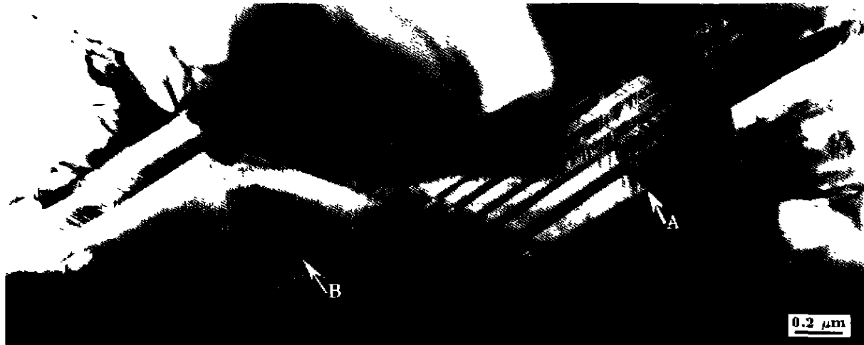
图 6 退火态 MlNi_{3.8}Co_{0.75}Mn_{0.4}Ti_{0.05} 合金中的孪晶(A)与层错(B)
