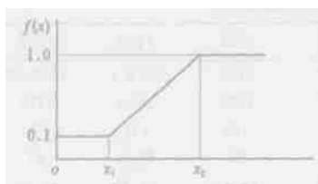
图1 S型隶属度函数曲线
