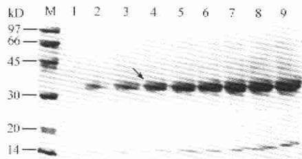
图 4 发酵罐中酵母表达的木聚糖酶 XYNB' 的 SDS-PAGE 分析
