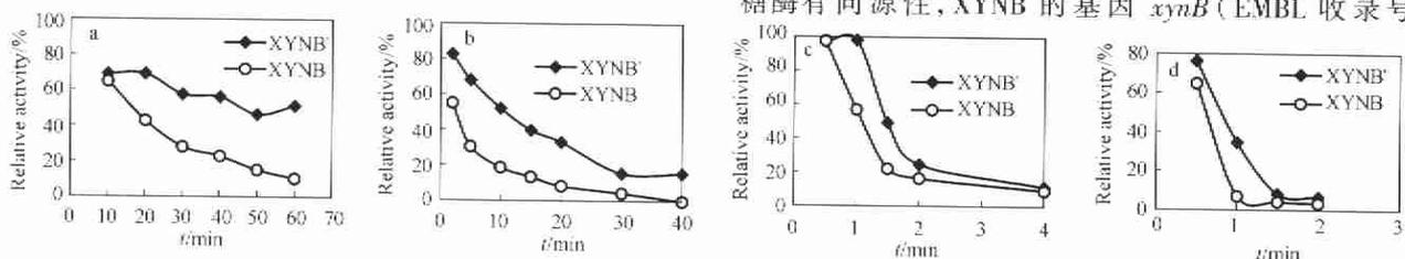
图 6 突变酶 XYNB' 和原酶 XYNB 在不同温度下的热稳定性比较
