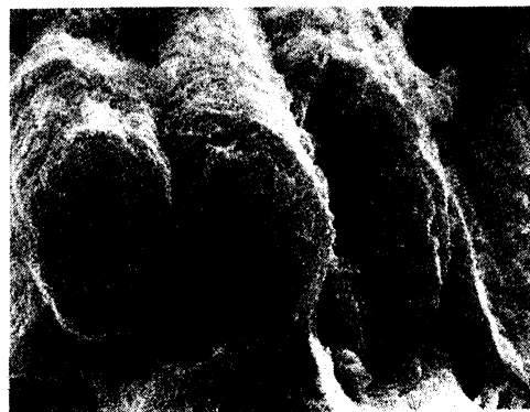
图 4 发生基体的剥蚀撕裂的碳纤维断口形貌
